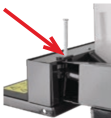
Obr. 3: Os otáčania ovládacieho ramena
