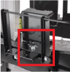
6. ábra: Szárnyas csavar a fa befogóján
