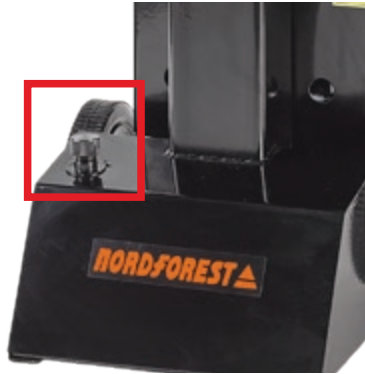
Fig. 11 : Vis de remplissage avec jauge de mesure d'huile
