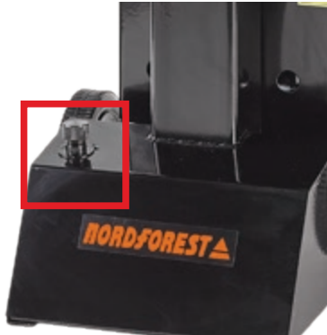
Kuva 11: Täyttöruuvi ja öljyn mittatikku
