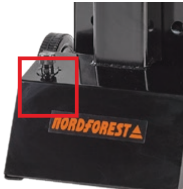
Obr. 9: Plniaca skrutka s tyčkou na meranie stavu oleja
