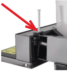
Abb. 3: Drehachse des Betätigungsarms
