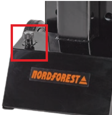
9. ábra: Betöltő csavar nívópálcával
