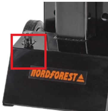
Fig. 9: Påfyllningsskruv med oljesticka
