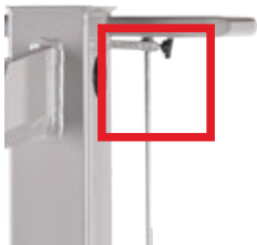
7. ábra: Csillagmarkolatos csavar a kapcsolórúdon
