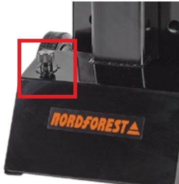
Kuva 9: Täyttöruuvi ja öljyn mittatikku
