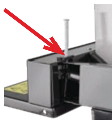
3. ábra: A működtető kar forgástengelye
